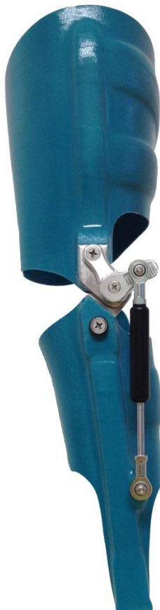
Abbildung: KAFO mit Liber-Extensor-N-28 Krafteinheit mittig = 100 % Kraft Kniebeugung (Anschlag) von 115 °
